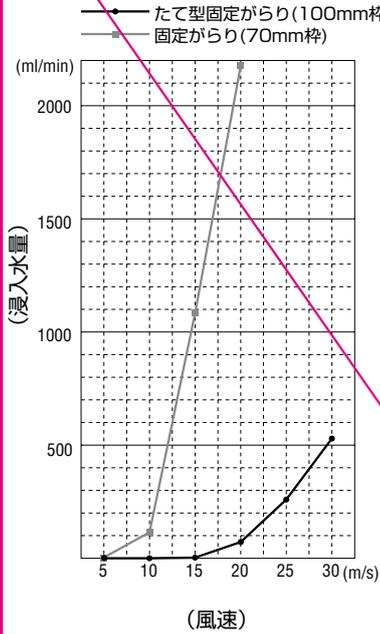
●風速 15m/s の場合 (※) 同じ散水量に対してたて型は 1.75ml、横型は 1083.69ml。
